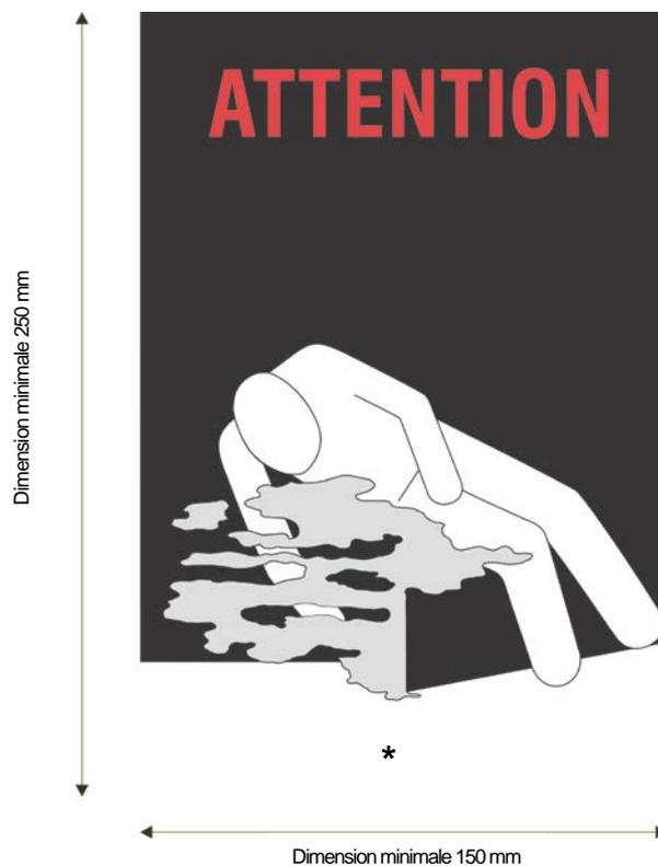
Marque de mise en garde contre l'asphyxie pour les véhicules et conteneurs
